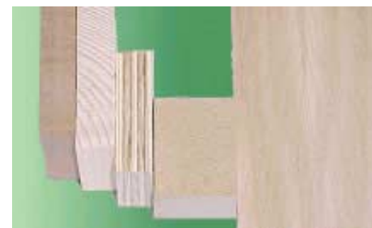
De derecha a izquierda las maderas que se ven en la foto son: Teka, Pino, Contrachapado, DM, Roble
